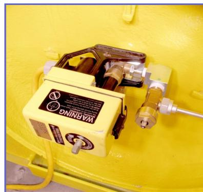
IV-830 avec actionneur d'arrêt d'urgence sur un conteneur d'une tonne avec connecteur
