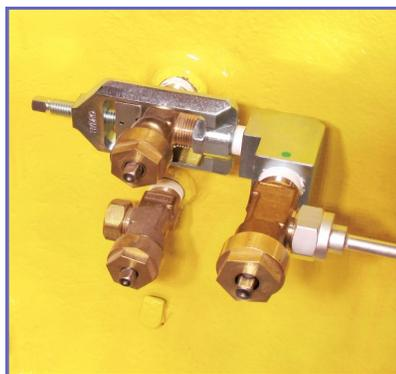
IV-830 monté sur un conteneur d'une tonne avec connecteur flexible.
